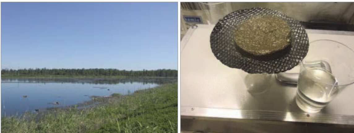
Figure 3. Lagune de décantation de boues (à gauche) et séparation phase liquide/phase solide par essorage (à droite)
